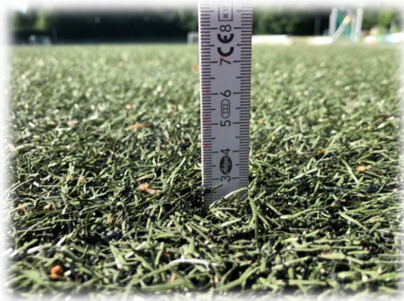
Verfüllung auf Minimum, Faser liegt und spleißt auf.
