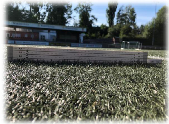
Verfüllung auf Minimum, Faser liegt und spleißt auf.
