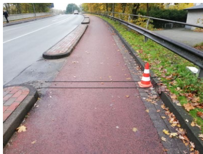
Mobile Zählstation mit Zählschläuchen in Lingen (AGFK 2021)
