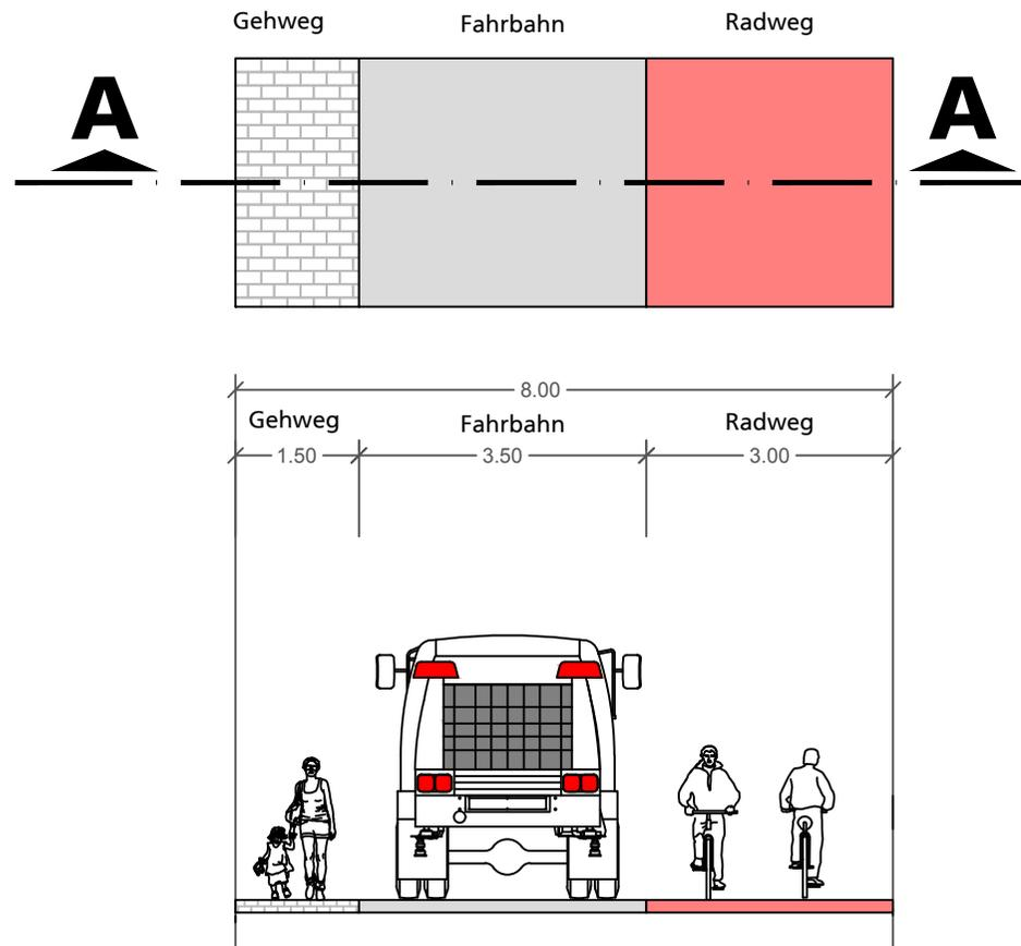
Benennung: Verbindungsstraße Variante 2 - Querschnitt A-A
