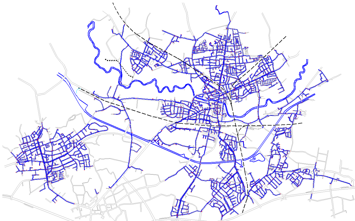
Abbildung 31: Leitungsnetz der Stadtwerke Lünen GmbH
