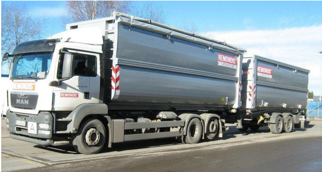
Abbildung 9: Beispiel Container-Fahrzeug - Großraum-Abrollkipper (Quelle: Remondis)
