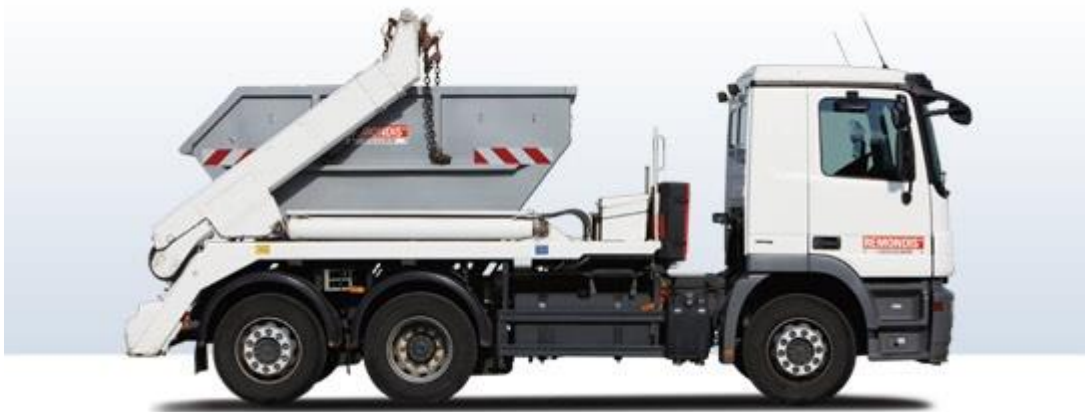
Abbildung 11: Beispiel Containermulden-Fahrzeug – Absetzkipper (Quelle: Remondis)
