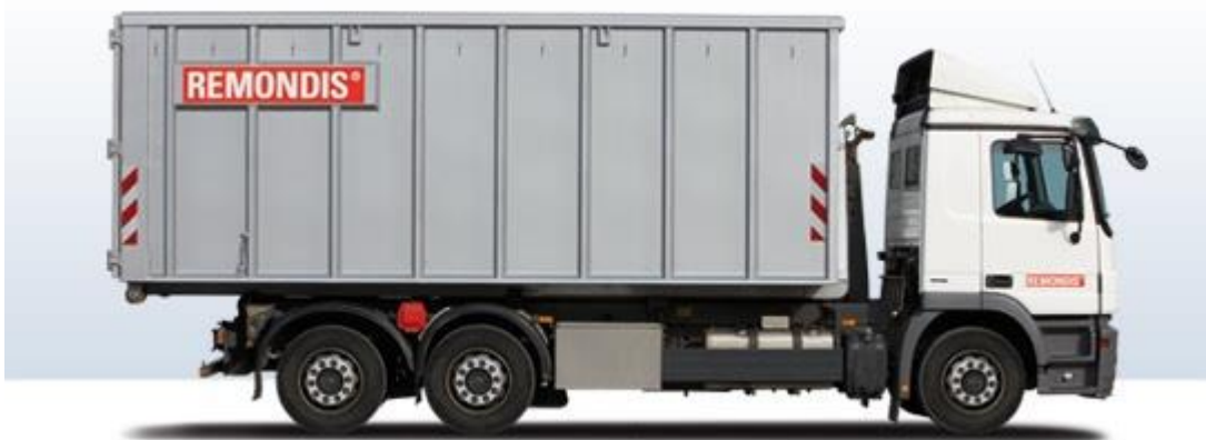
Abbildung 10: Beispiel Container-Fahrzeug – Abrollkipper mit Einzelcontainer (Quelle: Remondis)
