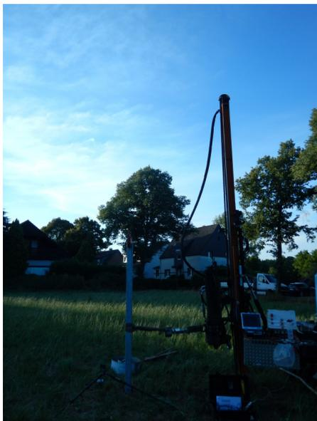
**Bild 6** – Messaufbau Probelastung und Versickerungsversuch m Untersuchungspunkt Nummer 1
