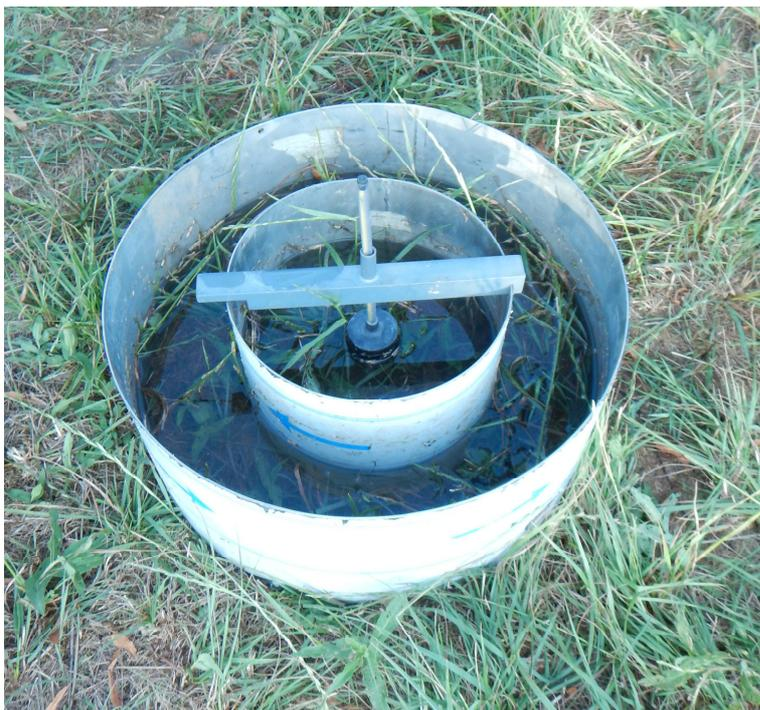
**Bild 2** – Versickerungsversuch am Untersuchungspunkt Nummer 1
