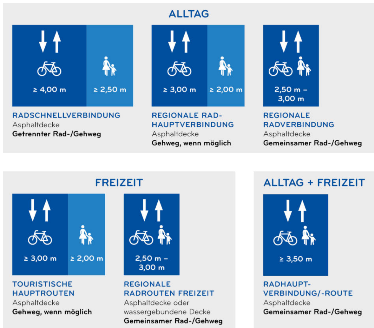
Abbildung 7-1: Qualitätsstandards für verschiedene Radwegeverbindungen mit separater Führung in Lünen und Bergkamen im Rahmen der Maßnahmenableitung zur IGA 2027, eigene Darstellung nach [8]
