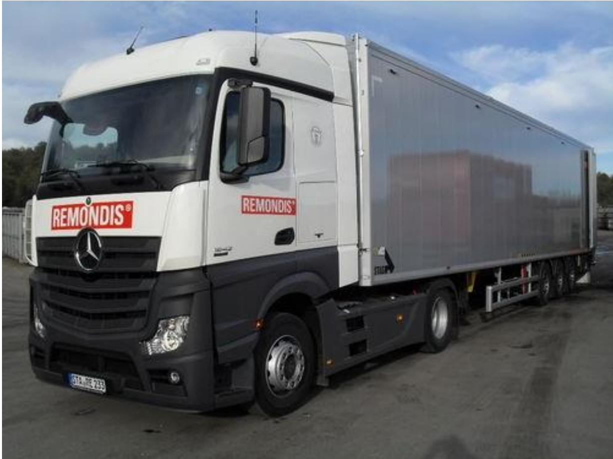
Abbildung 7: Beispiel Schubboden-Fahrzeug (Quelle: Remondis)
