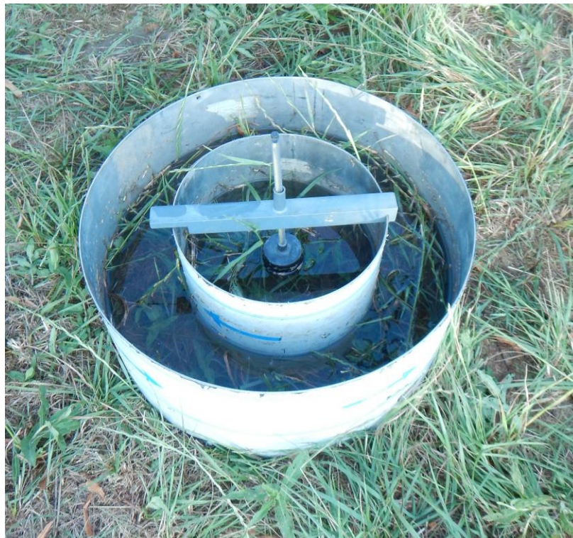
Versickerungsversuch an Untersuchungsstelle P1
