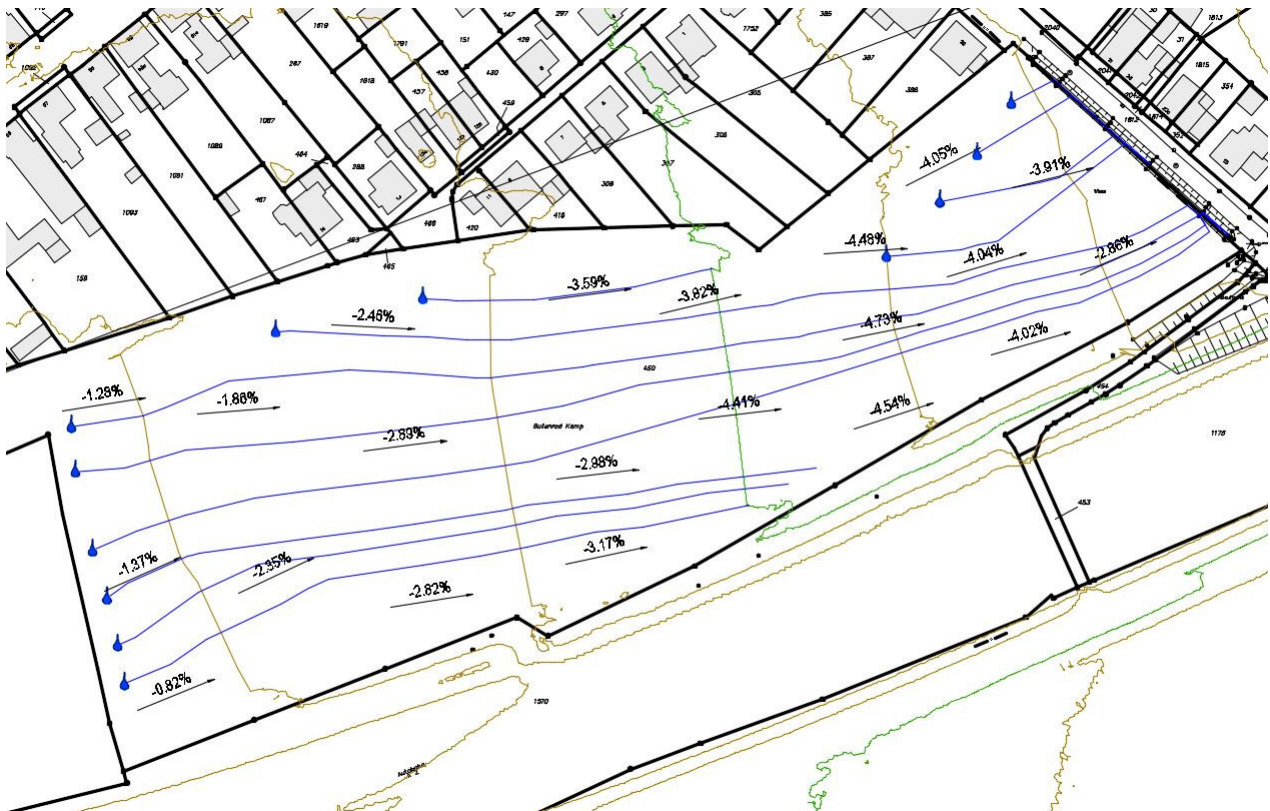
Abbildung 2 – Darstellung mittlerer Geländeneigungen und dem Geländegradienten folgender Fließwege
