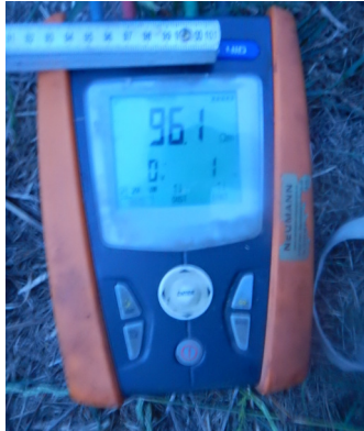
Bild 5 – Elektrischer Bodenwiderstand am Untersuchungspunkt Nummer 4
