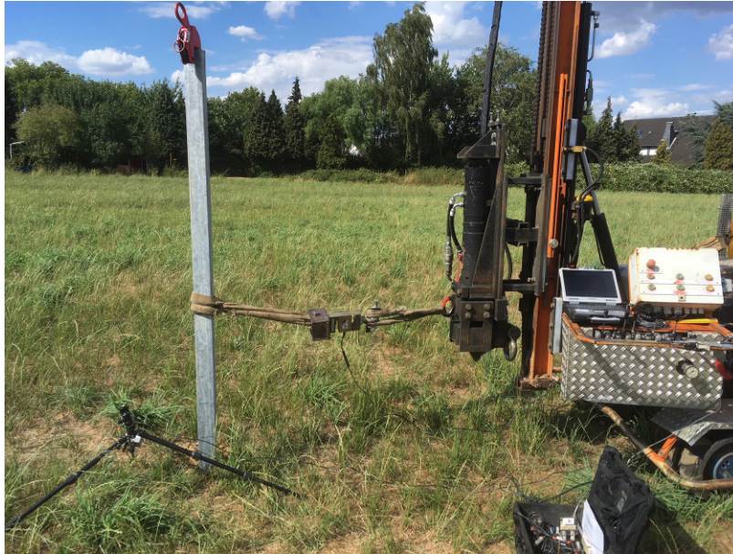
Vorbereitung horizontaler Zugversuch
