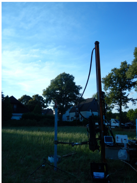
Bild 6 – Messaufbau Probelbelastung und Versickerungsversuch m Untersuchungspunkt Nummer 1
