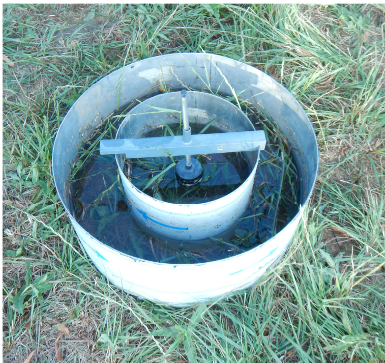
Bild 2 – Versickerungsversuch am Untersuchungspunkt Nummer 1
